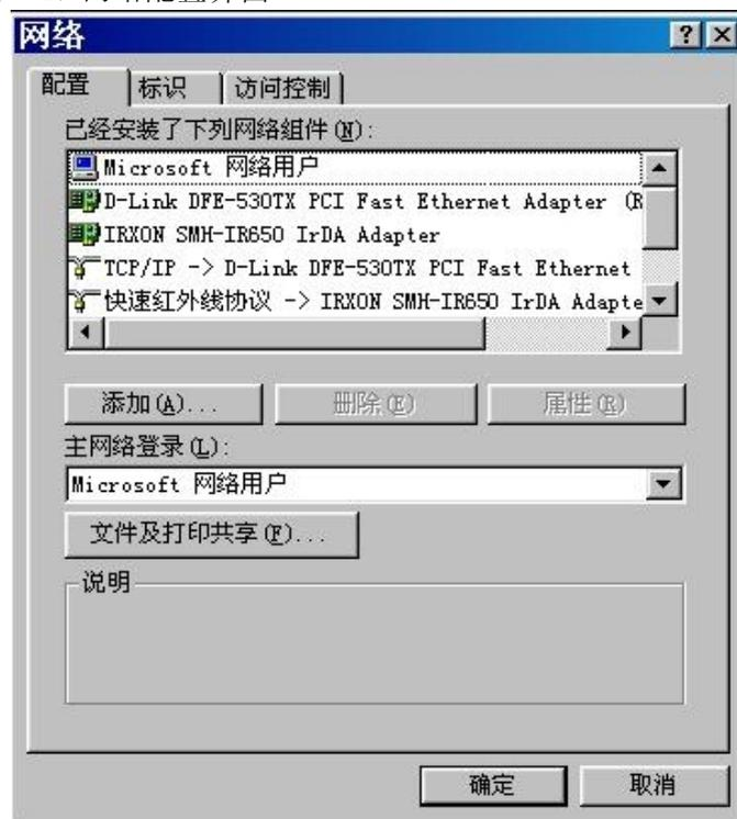
选择配置页面 TCP/IP 的属性，如果看到多个网络适配器，选择用来配置 NePort 设备服务器网卡的 TCP/IP 属性。
