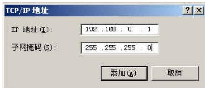
按上图内容填入 IP 地址 192.168.0.1~255，按“添加”按钮关闭窗口。按“确认”关闭设置窗口，即可设置 NePort 设备服务器了。
