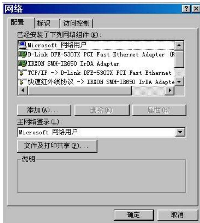
选择配置页面 TCP/IP 的属性，如果看到多个网络适配器，选择用来配置 NeChip 设备服务器网卡的 TCP/IP 属性。
