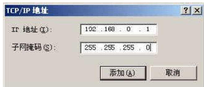
按上图内容填入 IP 地址 192.168.0.1~255，按“添加”按钮关闭窗口。按“确认”关闭设置窗口，即可设置 NeChip 设备服务器了。
